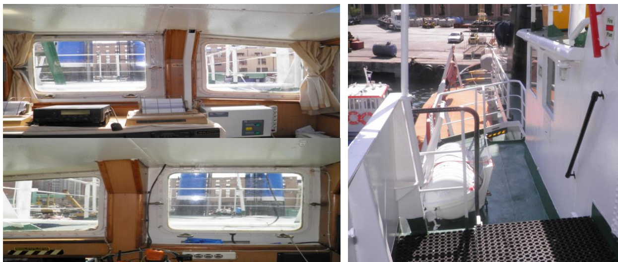
Εικόνα 25: Η οπτική επαφή από την γέφυρα προς την πρύμη του Ρ/Κ-Ν/Γ και από το ΑΡ εξωτερικό κατάστρωμα της (φερό γέφυρας).
