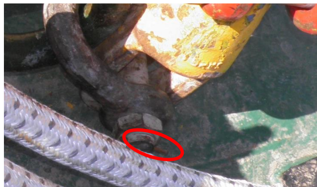
Εικόνα 17: Η θέση της κοπίλιας ασφαλείας όπως ήταν τοποθετημένη πριν την αφαίρεσή της .
