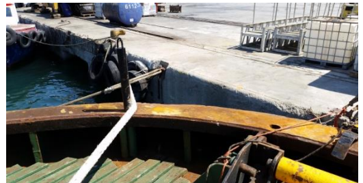
Εικ. 12: Αριστερά: Τυπικοί ορθοστάτες (norman pins - towing guiding pins). Δεξιά: Οι ορθοστάτες, τοποθετημένοι στις μόνιμες υποδοχές κατά την πρόσδεση του Ρ/Κ-Ν/Γ.
