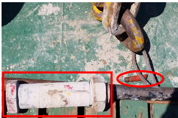
Εικόνα 16: Απεικόνιση του περικοχλίου και του κοχλιωτού πείρου του ναυτικού κλειδιού και της κοπίλιας ασφαλείας
