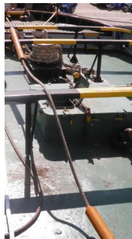
Εικ. 8: Το κύριο ρυμούλκιο
