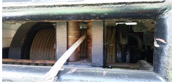
Εικ. 4: Το μόνιμο άνοιγμα στην φρακτή, εκ του οποίου διήρχετο το κύριο ρυμούλκιο διαμέσου κάθετου τονοδηγού,
