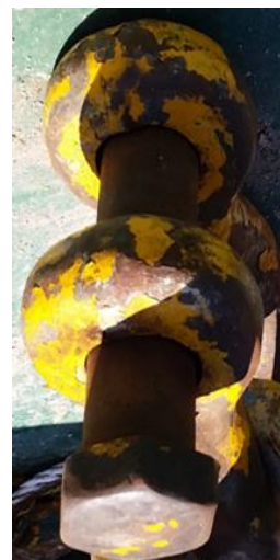
Εικ. 23.1 : Ενδεικτική απεικόνιση της κατακόρυφης θέσης, στην οποία εκτιμάται ότι βρέθηκε το ναυτικό κλειδί και ο κοχλιωτός πείρος με αποτέλεσμα την απελευθέρωσή του λόγω βαρύτητας.
