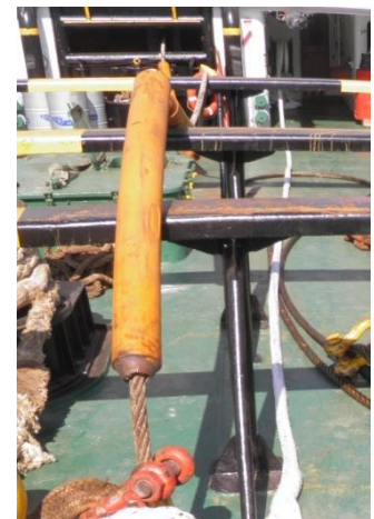
Εικ. 9: Το συρματόσχοινο παρεμβολής και η καδένα.
